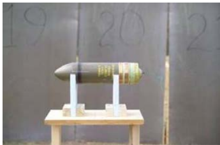
شکل ۲: استقرار یک پرتابه جهت ترکش‌گیری استاتیکی
