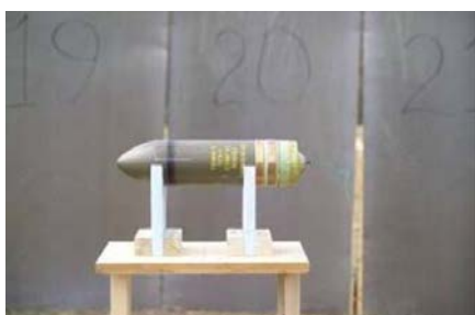
شکل ۲: استقرار یک پرتابه جهت ترکش‌گیری استاتیکی
