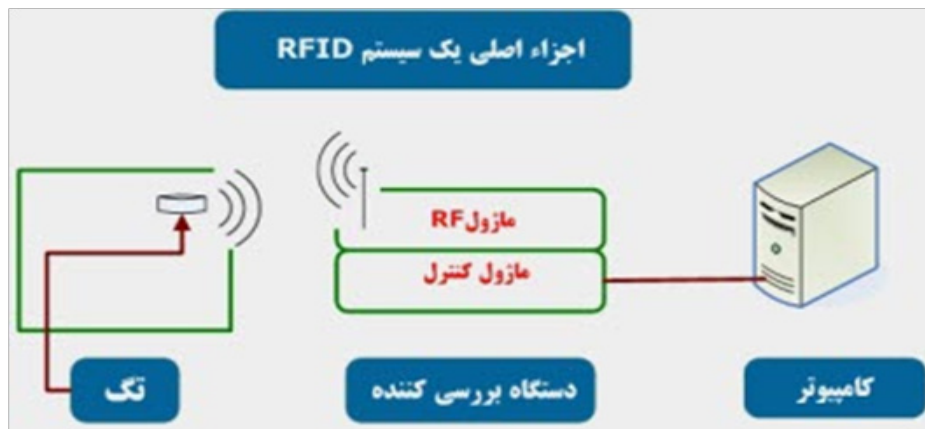
شکل ۲. اجزاء یک سیستم RFID
