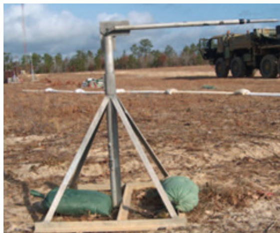
شکل ۴: حسگرهای فشار مدادی میدان تست
