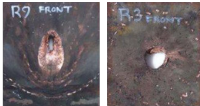
شکل ۱۸: نتیجه ی تست نفوذ یک سرجنگی در زره RHA (سمت راست: با زاویه ۹۰ درجه و سمت چپ: زاویه ۴۵ درجه)
