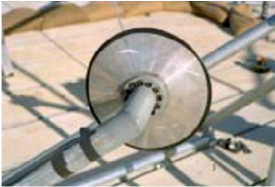
شکل ۳: حسگرهای فشاری در میدان تست
