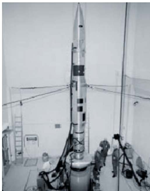
شکل ۲- نمونه ای از آزمون شرایط محیطی ارتعاش مربوط به یک موشک هدایت شونده در حالت عمودی
